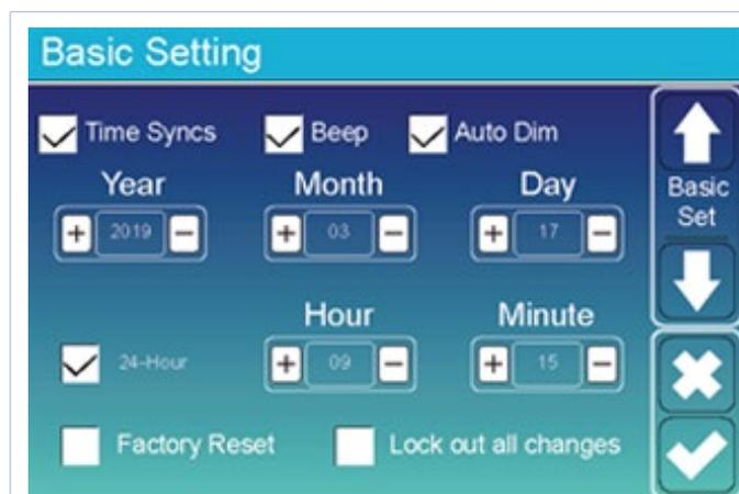
**Factory Reset (Заводские настройки):** сброс всех параметров инвертора.
