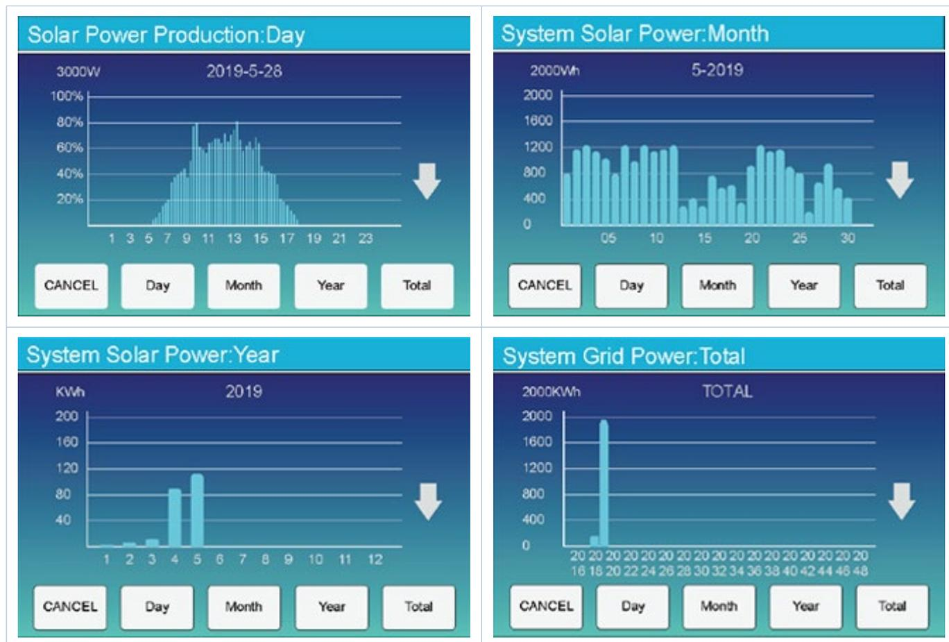
На ЖК-дисплее можно просмотреть ориентировочные графики выходной мощности массива ФЭМ за сутки, месяц, год и за весь период. Точную информацию о выработке электроэнергии см. в системе мониторинга. **Нажмите стрелки вверх и вниз, чтобы проверить график выходной мощности для разных периодов.**
