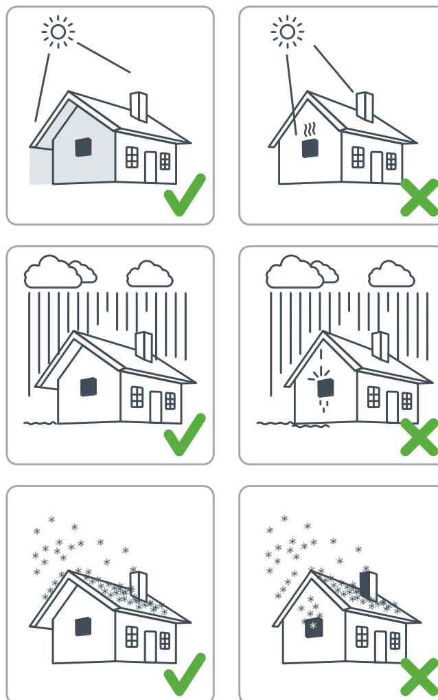
Рисунок 3.3.1 Правила расположения инвертора на фасаде здания
